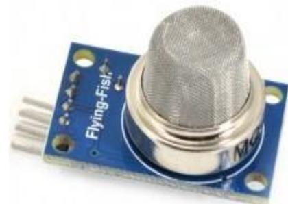
**Fig6: MQ2(Gas) Sensor**
