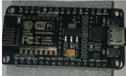
**Fig. 3. ESP8266 NodeMCU**
