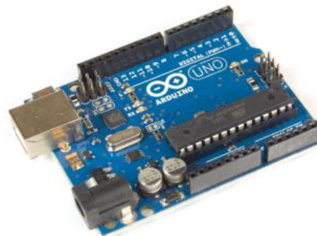
Fig. 3: Arduino UNO R3
