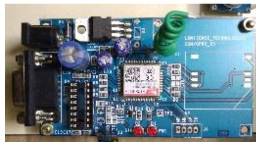
Fig. 4: SIM800C GSM Module
