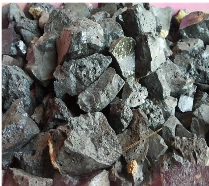
Fig. 2: Steel Slag
