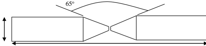
Fig: 3.2 Double V-Groove Test Specimen
